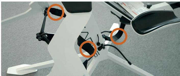
安全ベルトを取り付けましょう。上写真のようにベルトが取り付けられていることを確認してください。安全ベルトが取り付けられていなかったり、正しく取り付けられていない場合、ケガの原因になります。詳細は組立説明書に記載されています。
