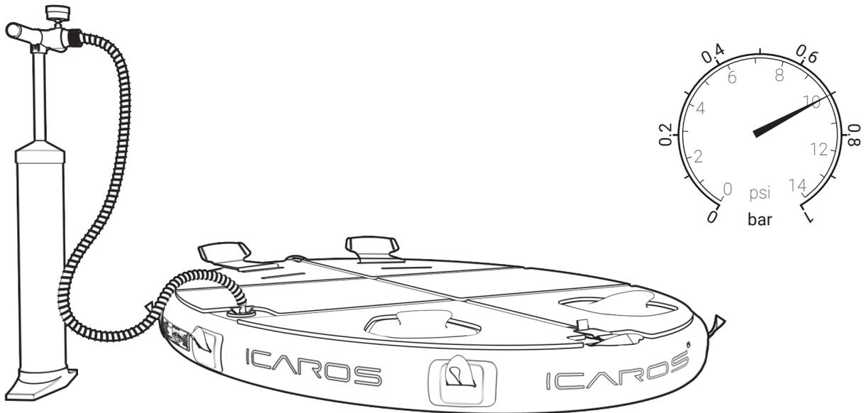
ICAROS Cloudを安全に空気を入れるには、まず上側のチャンバーを膨らませてください。ICAROS Cloudを床に広げてください。上側のチャンバーに注入される空気圧は、最低10psi / 0.7 bar、または最大14psi / 1 barでなければなりません。理想的な圧力は、12 psi / 0.85 barです。注入後、弁の保護カバーが閉じていることを確認してください。
