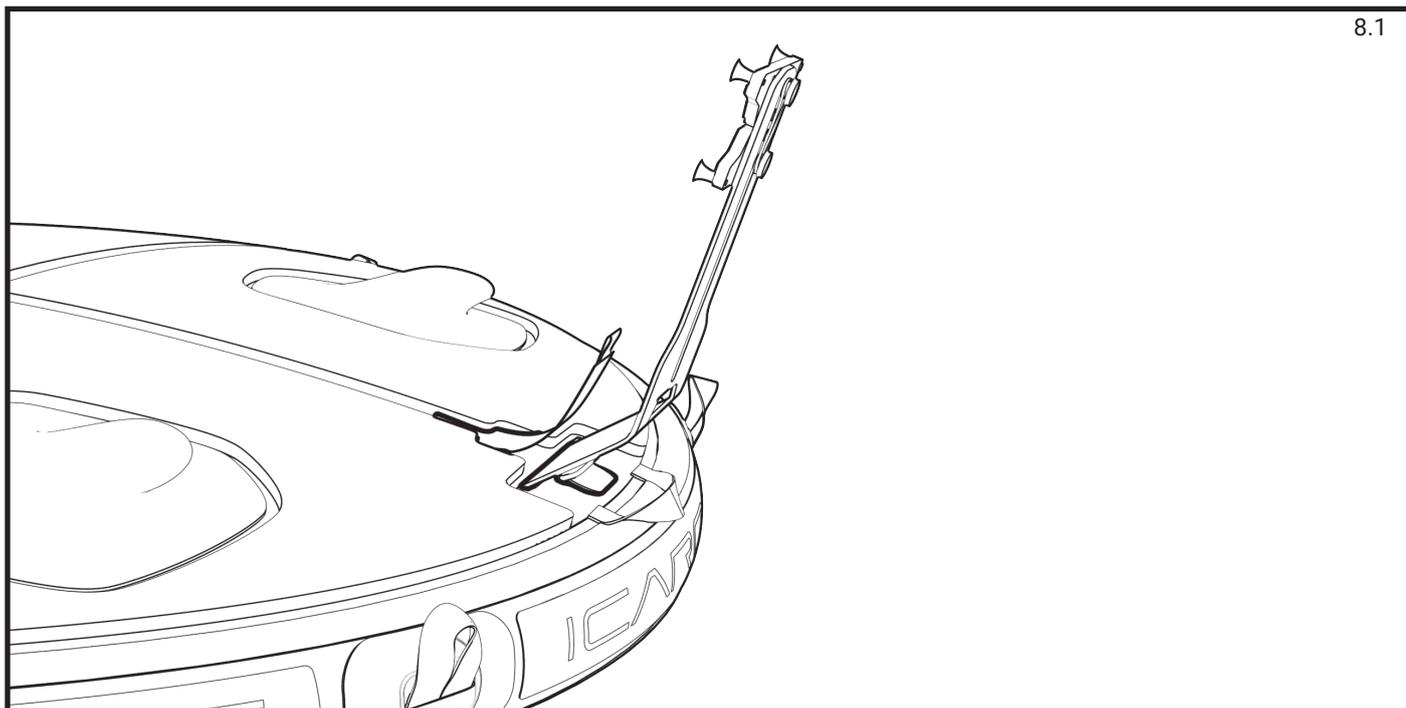
前方の中央ポケットに、タブレットホルダーを丁寧に入れて、中まで押し込んでください。その際力を入れないでください、ポケットが破損する可能性があります。
