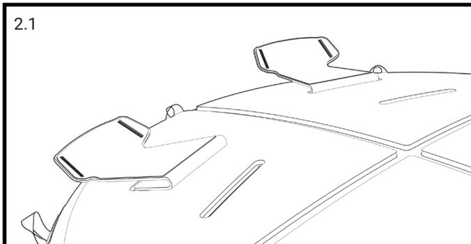
ICAROS Cloudの上のポケットに、フットレストを慎重に入れて、中へ押ししてください。ポケットが破損する可能性がありますので、力を入れないでください。
