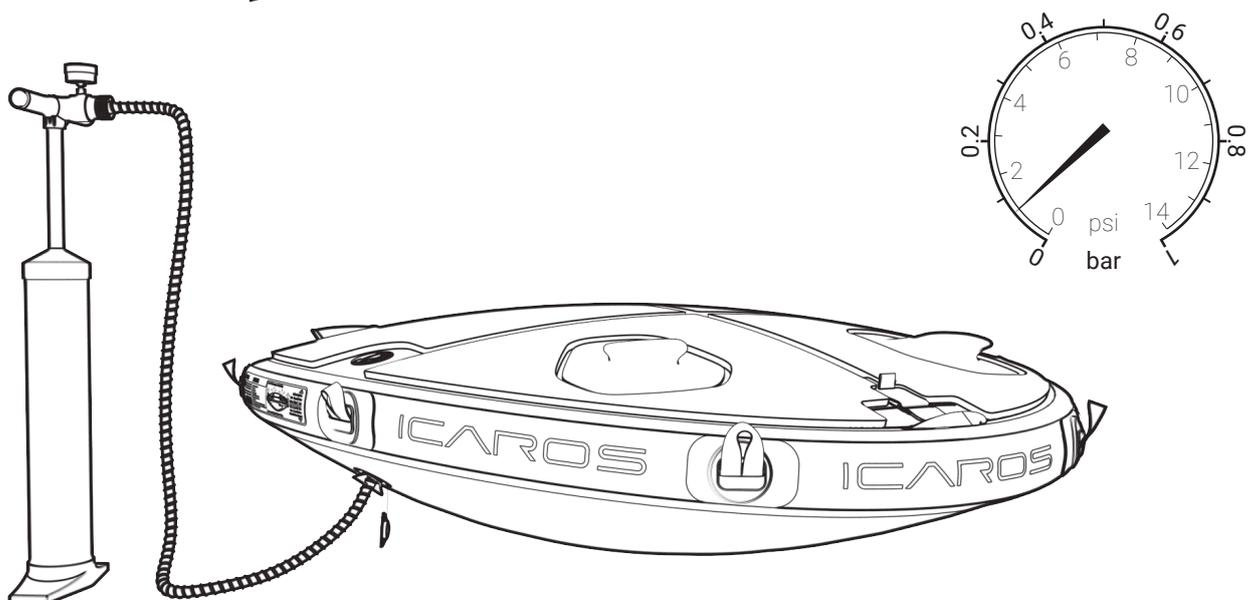
下側のチャンバーに圧送される空気圧は、最低0.2 psi / 0.01 bar、または最大 0.8 psi / 0.05 barでなければなりません。下側の理想的な圧力は、0.5 psi / 0.03 barです。弁の保護カバーが閉じていることを確認してください。
